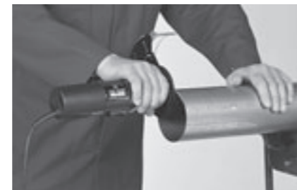
Afb. 10.0-8: Buitenkant ontbramen met elektrische buisontbramer RE 1
