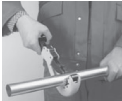
Afb. 8.0-34: Op maat snijden met buizensnijder
