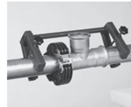
Afb. 8.0-15: Veilige montage van een rechte systeemleidingleiding
