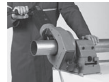
Afb. 8.0-4: Op maat zagen met mechanische zaag met elektromotor
