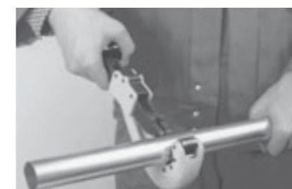
Afb. 8.0-2: Op maat snijden met buizensnijder
