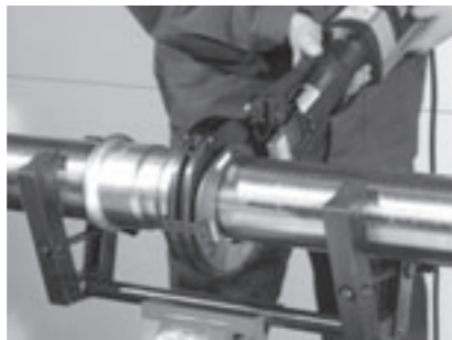
Afb. 8.0-51: Persproces (d = 42 – 108 mm)
