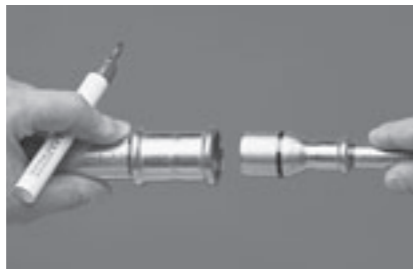
Afb. 8.0-9: Persfitting met inschuifuiteinde en markering van de insteekdiepte 'e'
