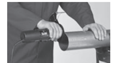
Afb. 8.0-6: Buitenkant ontbramen met elektrische buisontbramer RE 1
