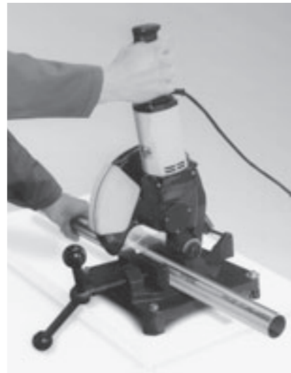
Afb. 10.0-6: Op maat zagen met een mechanischezaag met elektromotor
