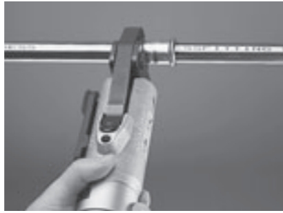
Afb. 8.0-50: Persproces (d = 12 – 35 mm)
