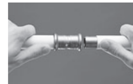
Afb. 8.0-49: Het inschuiven van de koperen buis in de persfitting
