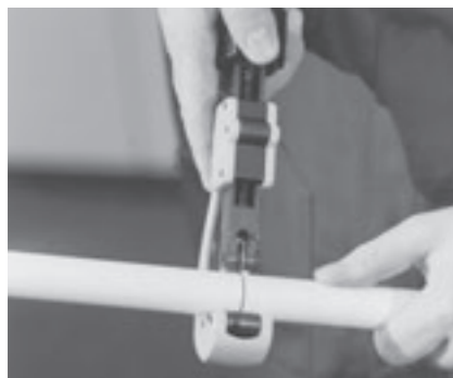
Afb. 8.0-41: Op maat snijden met een buizensnijder
