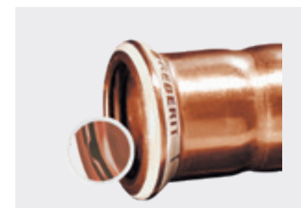
Gedefinieerde lekkagepaden maken niet verperste fittingen meteen herkenbaar bij de druktest.
