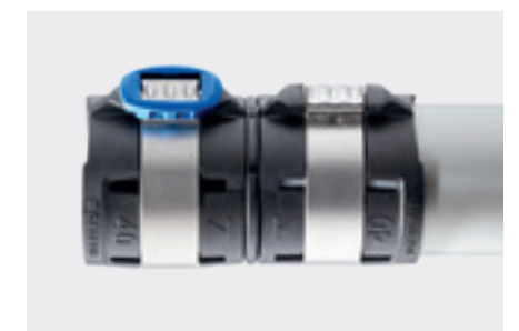
De niet verperste Geberit FlowFit fittingen zijn meteen herkenbaar aan de nog aanwezige gekleurde persindicatoren.
