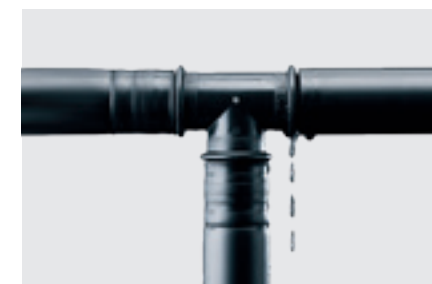
Gedefinieerde lekkagepaden maken niet verperste fittingen meteen herkenbaar bij de druktest.
