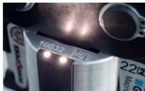
Een geïntegreerde perspuntverlichting bij de Geberit ACO 203plus, ECO 203 en ACO 203XLplus zorgt voor goed zicht in donkere hoeken
