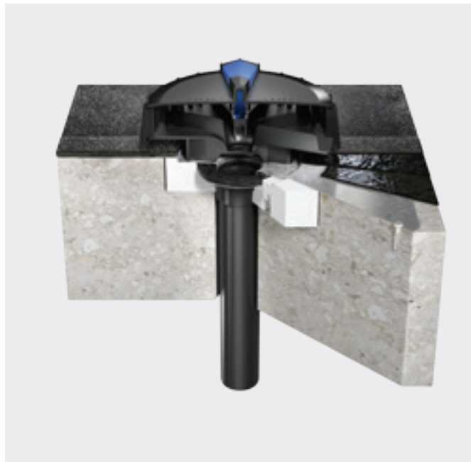
VOORBEELD 1: LICHTGEWICHT DAK, GEÏSOLEERD I.C.M. DAKFOLIE EN HET GEBERIT DAMPBARRIÈRE AANSLUITELEMENT Lichte daken genieten van de lage statische belasting dankzij Geberit Pluvia. De installatie gebeurt door middel van een flensverbinding, zodat de lange aansluitbuis probleemloos grote isolatiediktes kan overwinnen. Het Geberit dampbarrière aansluitelement kan zowel voor folie als bitumen worden gebruikt.
