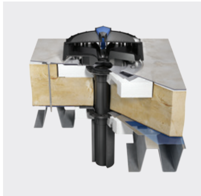
VOORBEELD 2: BETONNEN DAK MET DAKFOLIE OF BITUMEN De Geberit Pluvia trechter van bitumen heeft een aansluitplaat die groter is dan de standaardafmetingen en daardoor is een betere aanhechting verzekert. Zowel de trechter voor folie als de trechter voor bitumen worden direct ter plaatse vastgemaakt op de dakconstructie.
