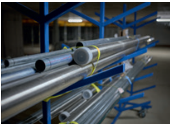
Eenvoudige montage dankzij de doorlopende, eenduidige labeling van de afgekorte buissecties.
