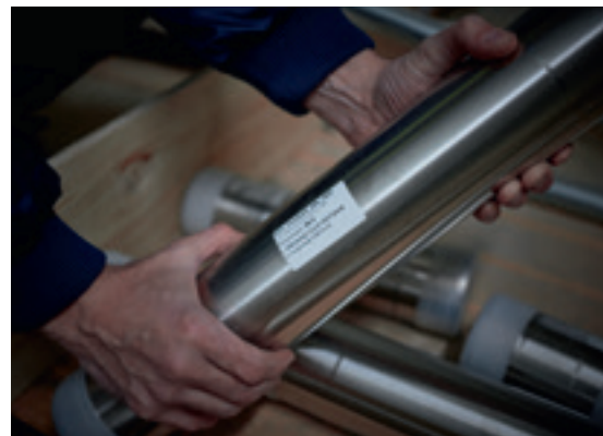
Eenvoudige montage dankzij de doorlopende, eenduidige labeling van de afgekorte buissecties.
