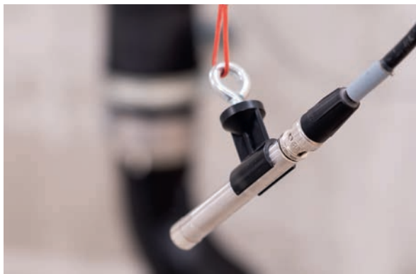
Akoestische metingen van de uitgestraalde luchtgeluiden van een Geberit Silent-db20 Sovent fitting.
